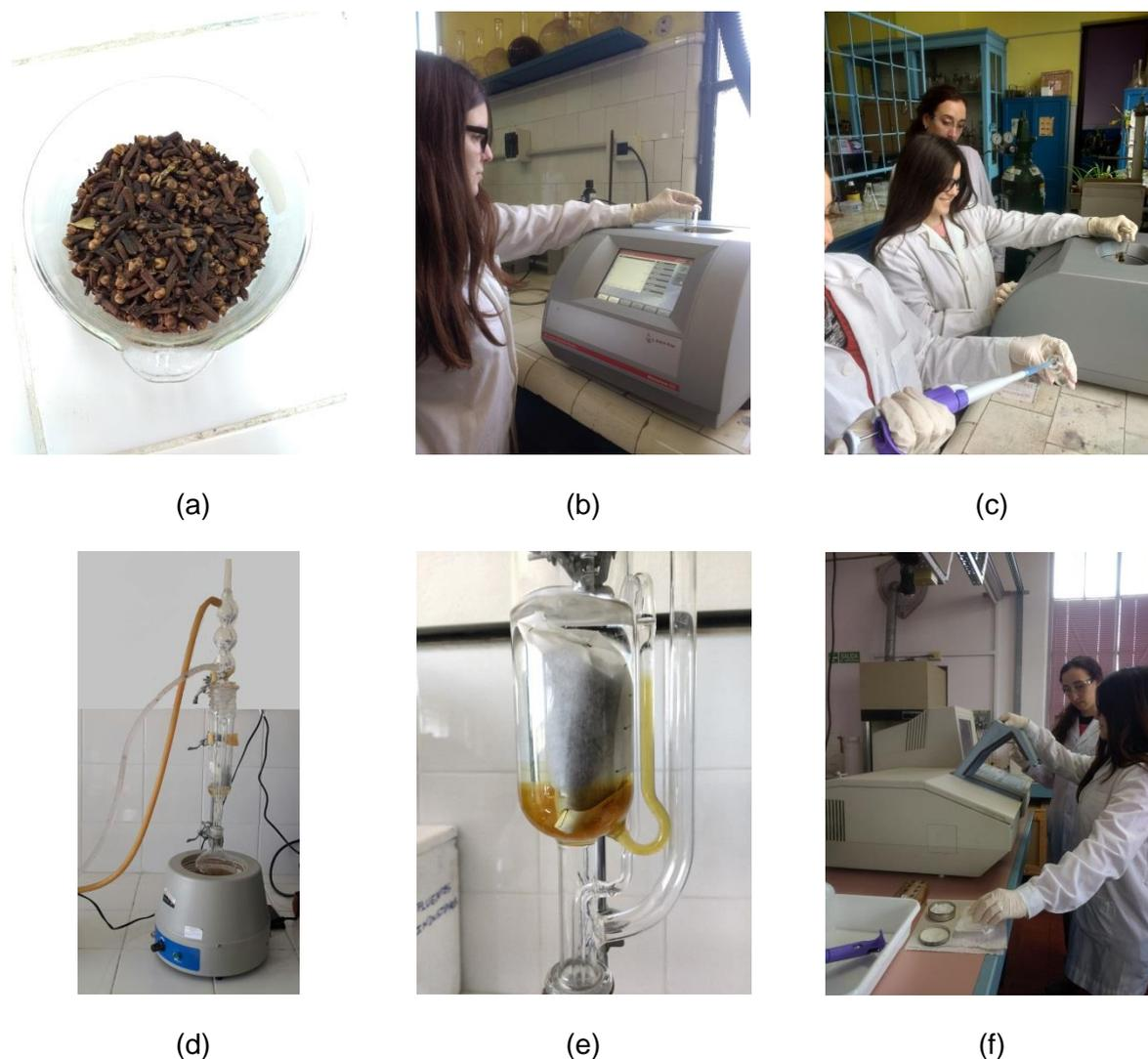
**Figura 1.** (a) Clavo de olor, (b-c) Extracción asistida por microondas, (d-e) Equipo Soxhlet, (f) Ensayo IR.
