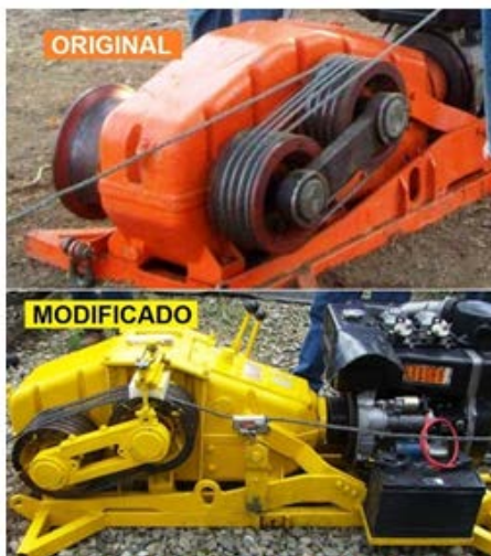
Figura 10. Malacates: Original y Modificado
