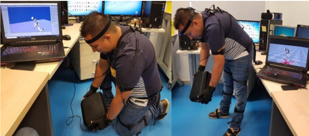
Figura 10. MOCAP en Tarea de Levantamiento Manual de Carga
