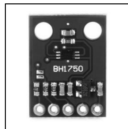
Fig. 6. Sensor de iluminación digital BH1750. Este sensor permite realizar mediciones de flujo lumínico (iluminancia) de forma sencilla a través del bus I2C.
