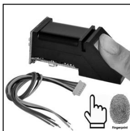
Fig. 2. Lector Óptico de Huellas Dactilares. Sistema sencillo de toma de reconocimiento de huellas dactilares que se almacenan en la memoria interna para su comprobación posterior
