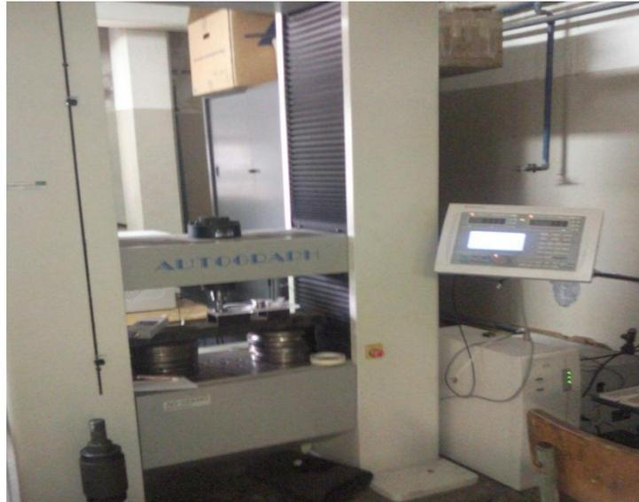
**Figura 4.2** Máquina de Ensayo Industrial Shimadzu AG.
