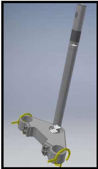
Figura 10.12 – Tensiones aplicadas a la columna de dirección
