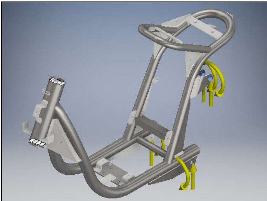
Figura 13.13 - Aplicación de los esfuerzos y sus anclajes - Test de rigidez torsional
