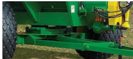
Figura 3. Punta de eje articulada y Avantren basculante
