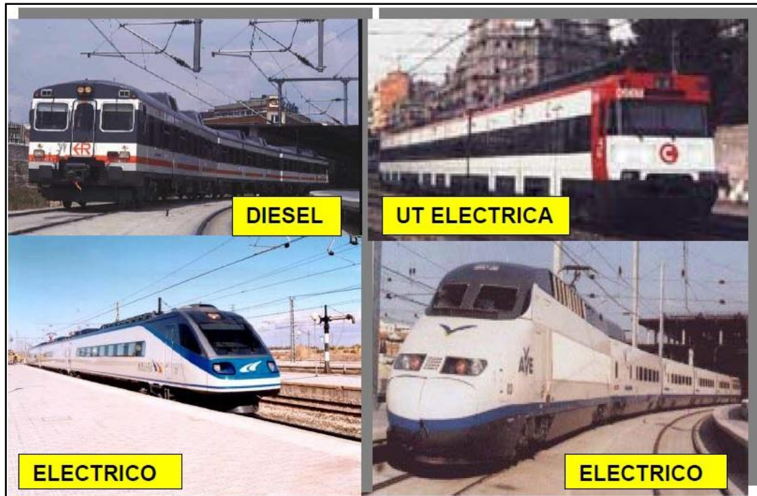
Figura Nº 14: Tipos de automotores ferroviarios.
