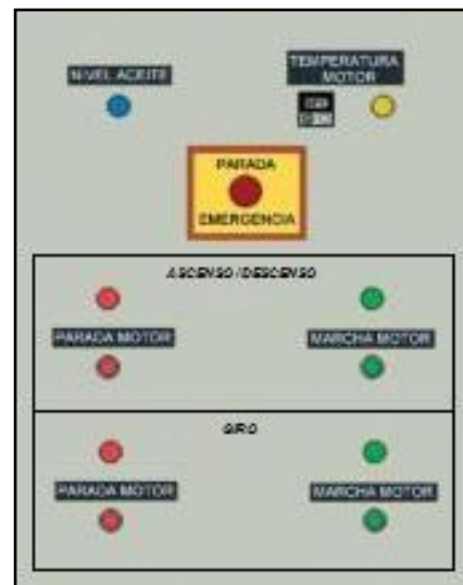
Figura N°82: Cuadro eléctrico de mando.
