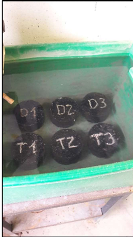
Imagen 23: Proceso de cálculo de densidad, inmersión de probetas
