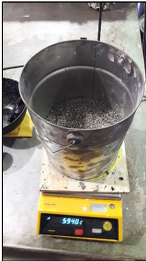
Imagen 30: Pesaje de los componentes de la muestra
