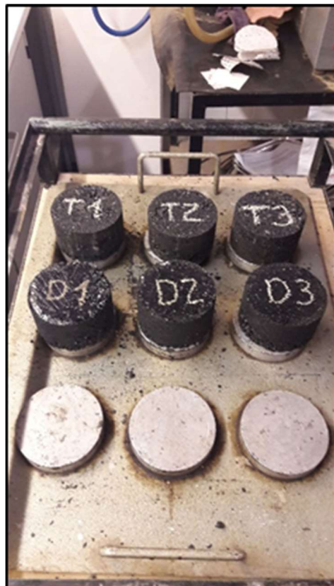
Imagen 20: Conformación de las probetas
