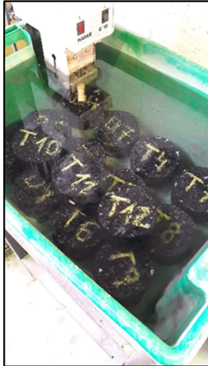
Imagen 27: Proceso de cálculo de densidad
