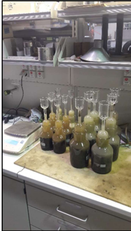
Imagen 15: Preparación de los picnómetros
