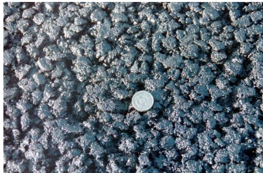
Imagen 6: Macrotextura de una carpeta de SMA
