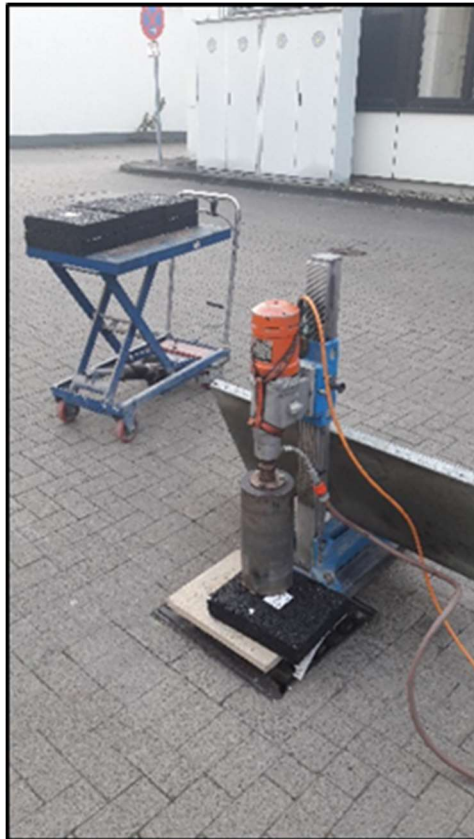
Imagen 40: Perforación de los núcleos de perforación
