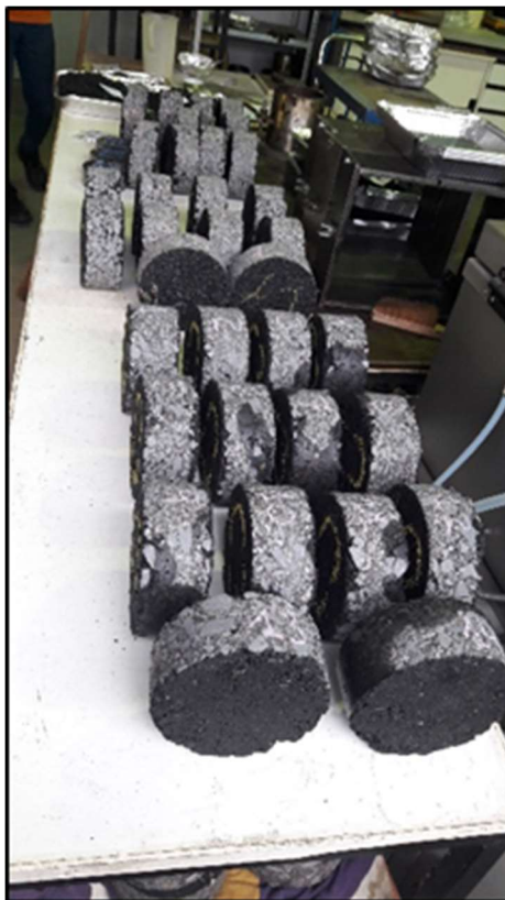
Imagen 44: Preparación para el ensayo de densidad aparente
