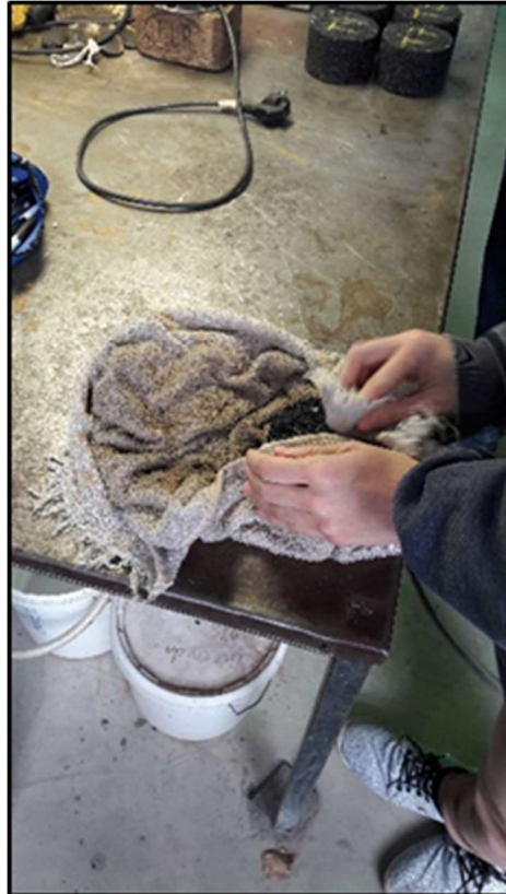
Imagen 25: Proceso de cálculo de densidad, secado de superficies de la probeta
