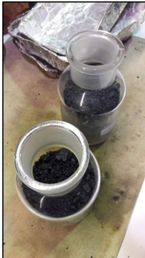
Imagen 35: Preparación para el ensayo de densidad aparente
