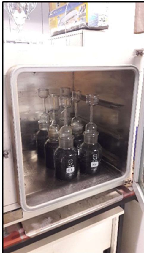
Imagen 37: Preparación para el ensayo de densidad aparente
