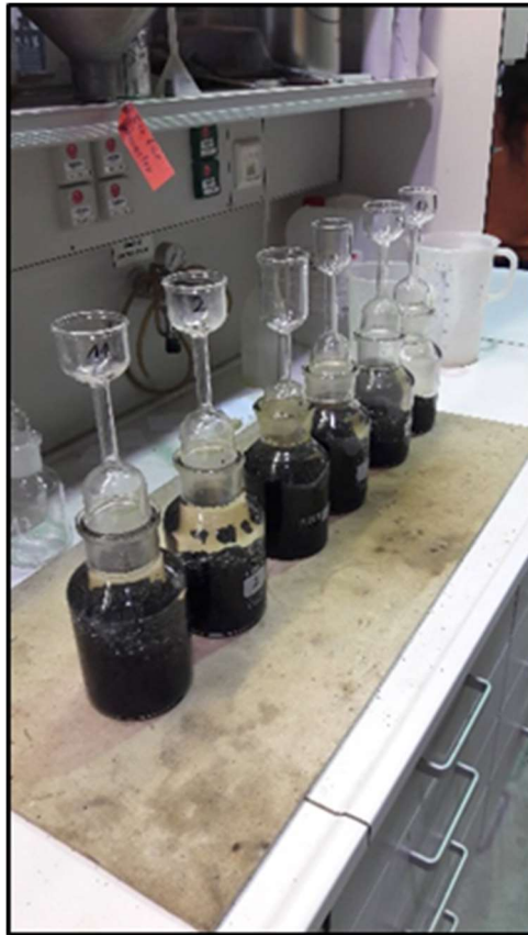
Imagen 38: Preparación para el ensayo de densidad aparente
