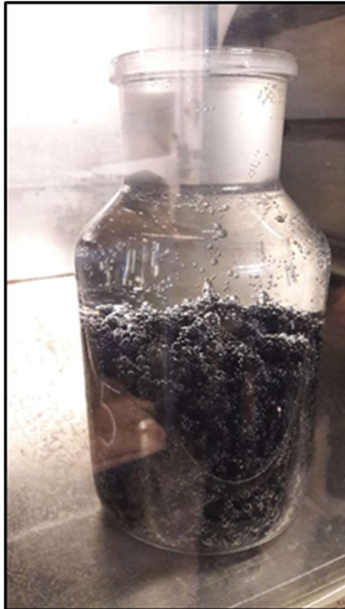
Imagen 36: Preparación para el ensayo de densidad aparente
