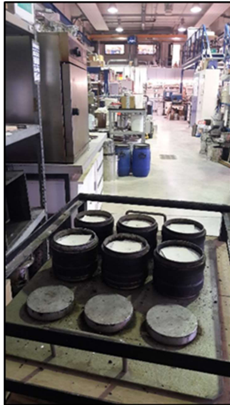
Imagen 19: Elaboración de las probetas
