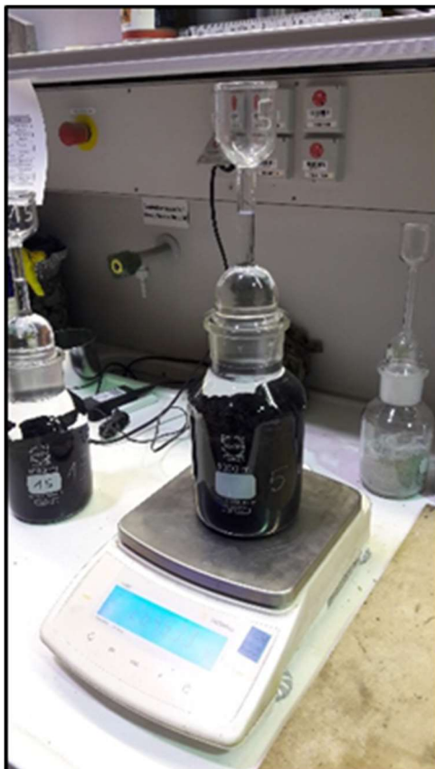
Imagen 39: Preparación para el ensayo de densidad aparente
