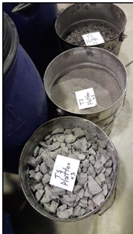
Imagen 31: Agregados para la conformación de la muestra
