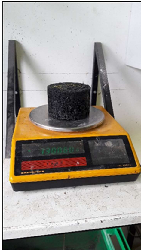
Imagen 26: Proceso de cálculo de densidad, pesaje de la muestra
