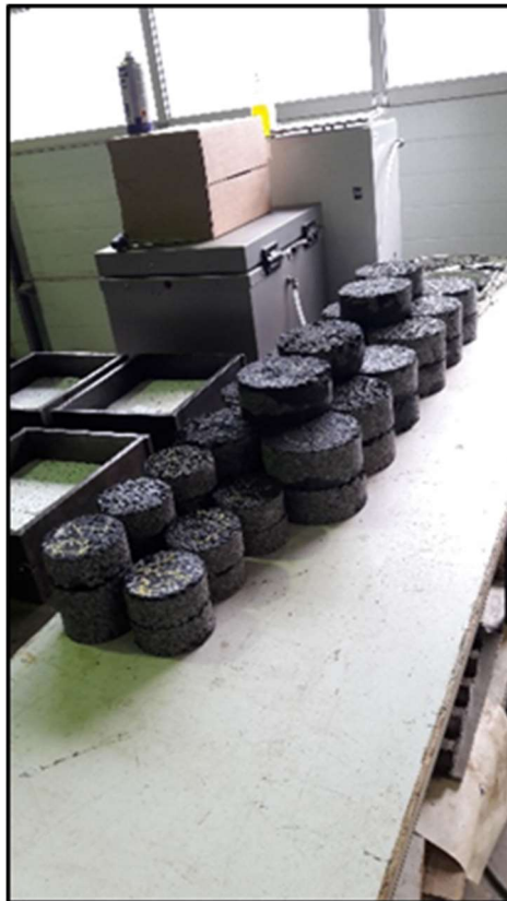
Imagen 44: Preparación para el ensayo de densidad aparente
