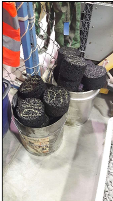
Imagen 28: Proceso de cálculo de densidad
