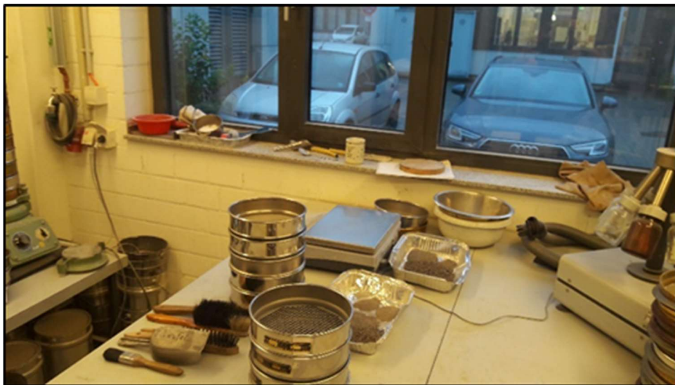
Imagen 13: Preparación de los tamices para el proceso de tamizado
