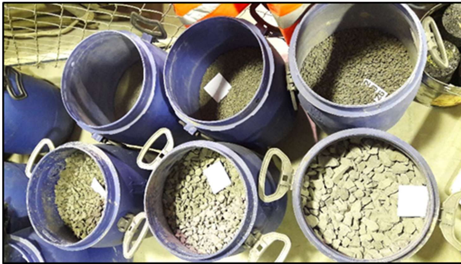
Imagen 12: Separación de los agregados en contenedores de distinto tamaño
