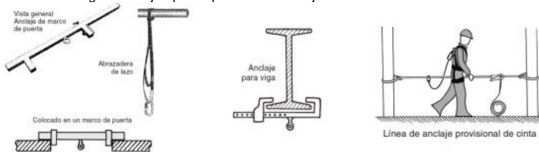
Figura 32. Ejemplos dispositivos de anclaje clase B. NTP 809. 2008
