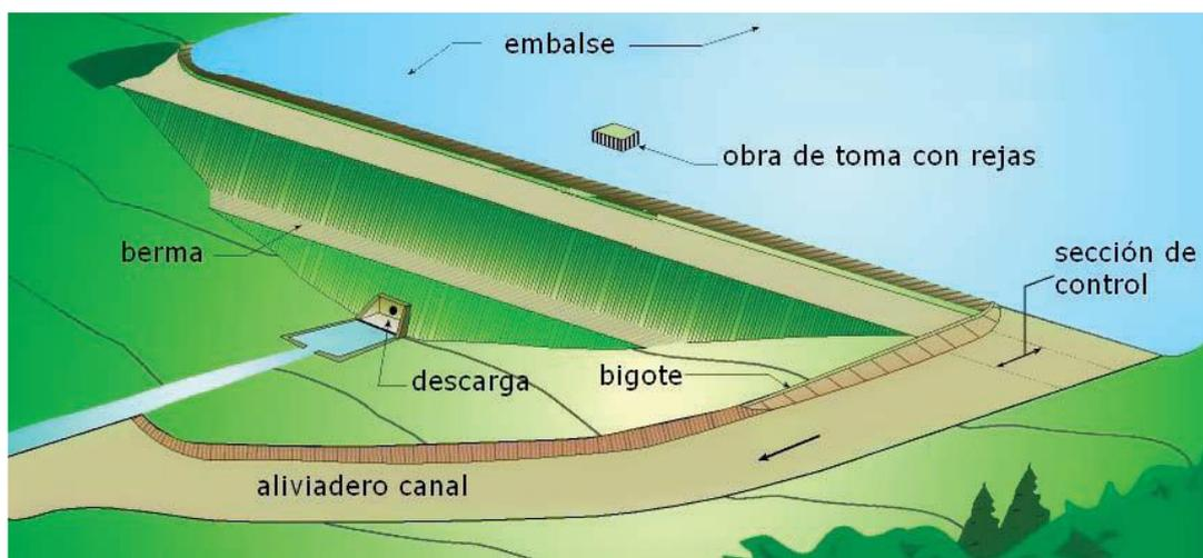
Fig.4: Elementos constitutivos de un embalse. Diseño y Construcción de pequeñas presas, 2011.
