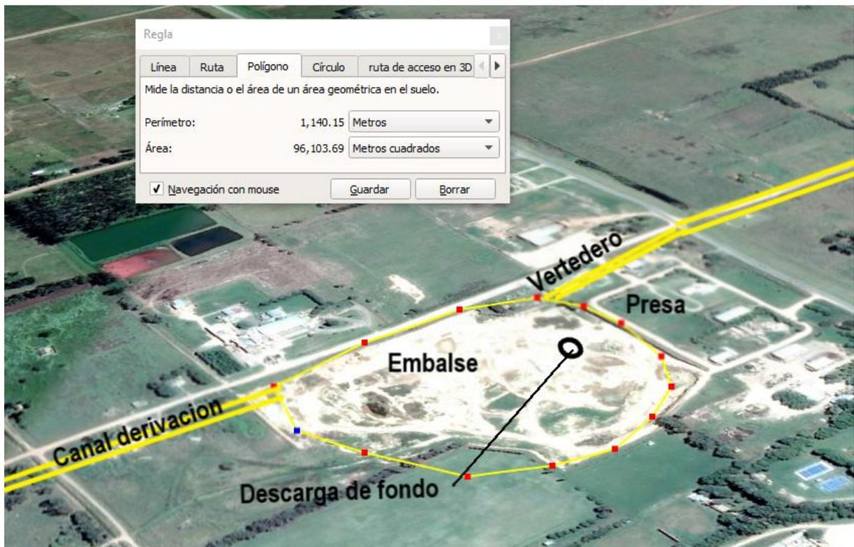
Fig. 3: Estructuras base del embalse control de crecidas Acceso sur, Ciudad de Ayacucho.
