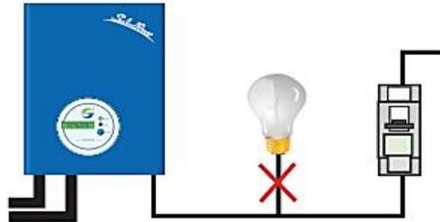
Fig. 17 Mala Conexión de la Carga con el Inversor
