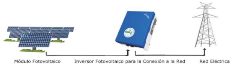
Fig.1 Sistema Solar para la Conexión a la red
