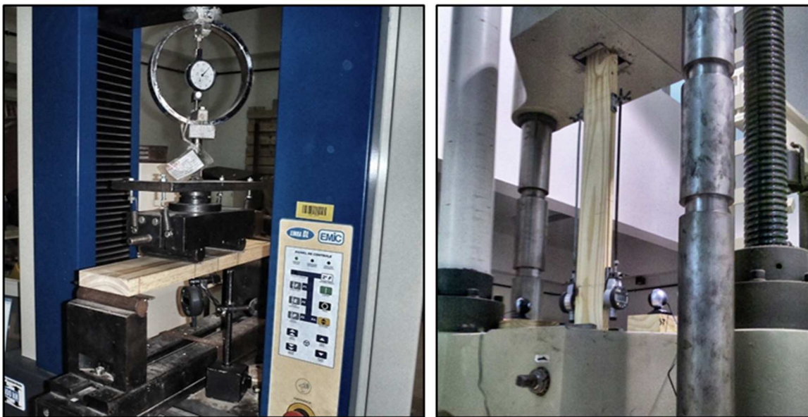
Figura 1. Ensayos estáticos. Izq.: Flexión de plano. Der.: Tracción.
