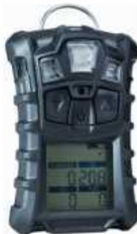
**Imagen 39**Equipo utilizado para la medición de gases – Obra RN N°75 La Rioja
