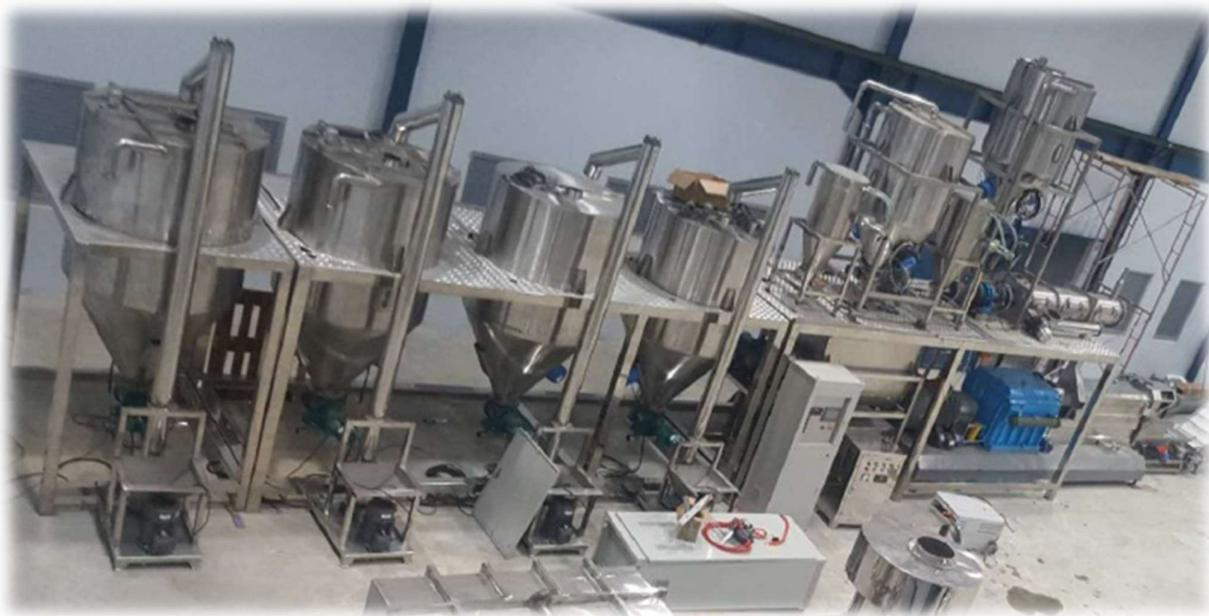
Automatizado bajo un sistema programado por PLC, el software da la orden de armado del Batch según se haya dispuesto en el programa semanal de producción. Antes de ingresar a la línea la materia prima es pesada por una balanza, y se realiza un segundo control visual por el operario a cargo del área. Una vez que el peso sea el correcto se dejara pasar el total del producto a la segunda etapa.
