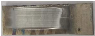
Fig. 2. Probeta del grupo con aporte de electrodo ER70S6 sometida a ensayo de desgaste abrasivo.
