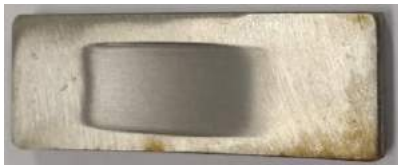
Fig. 1. Probeta del grupo de corrosión sometida a ensayo de desgaste abrasivo.
