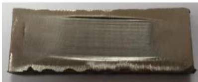
Fig. 3. Probeta del grupo con aporte de electrodo ER308L sometida a ensayo de desgaste abrasivo.
