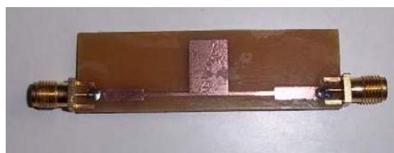
Fig. 1. Filtro pasa bajo construido.
