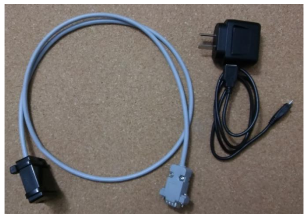
Figura 4. Cable de batería y datos (izquierda) y fuente conmutada con cable micro USB a USB-A usada (derecha). Se aprecia en el extremo izquierdo del cable de batería y datos una caja negra (convertor UART-USB).
