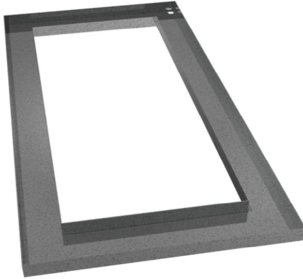
Figura 4.12 Canal de recolección de condensado
