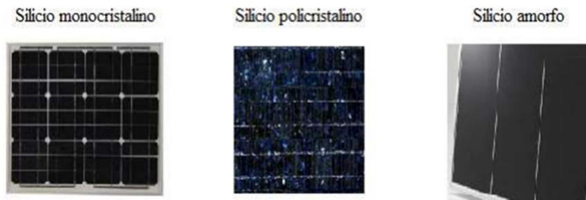
Figura 8.5 Tipos de células solares
