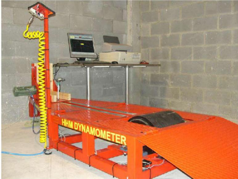
**Figura B:** Banco de potencia inercial en Bancada.
