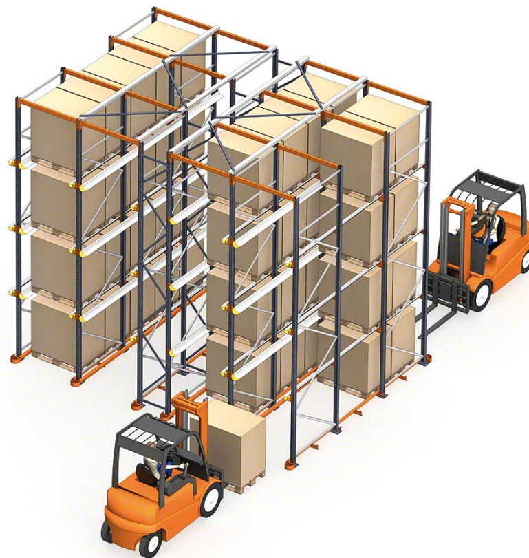
F 4.4 Estanterías Drive in out Fuente: Google Imágenes
