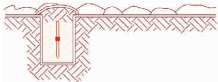
Suelo tratado con Gel mejorador de Resistividad de Suelos (dado el uso de una jabalina profunda o cable).
