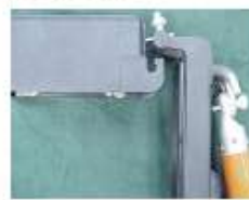
Colocación de brazo para cambio de fusibles
