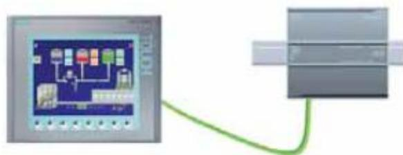
Conexión directa: HMI conectado a una CPU S7-1200
