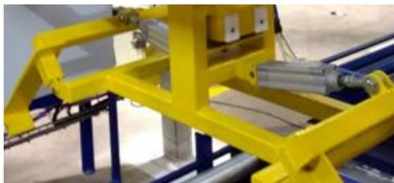
**Fig.Num°61:** Pistón de uñas del distribuidor.
