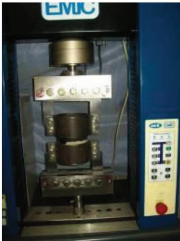
Figura 34. Ensayo de tracción de la unión
