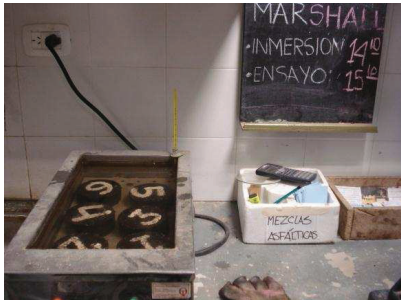
Figura 14. Inmersión en baño de agua termostataizado a 60 °C durante 40 minutos y ensayo de estabilidad/fluencia de las probetas
