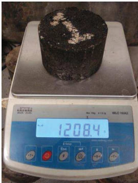
Figura 13. Determinación de peso al aire y peso sumergido de probetas Marshall
