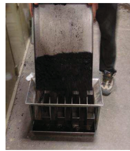
Figura 15. Disgregado y cuarteo de la mezcla para Densidad Rice y Recuperación
