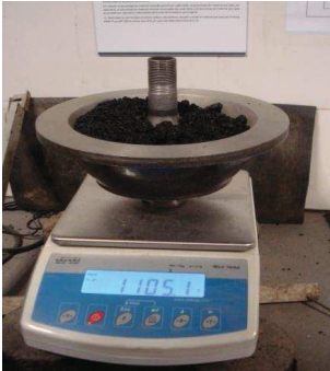
Figura 17. Determinación del contenido de asfalto por centrifuga
