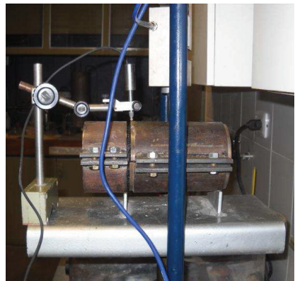
Figura 25 vista lateral de máquina para el ensayo de corte por flexión LCB
