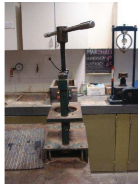
Figura 12. Compactador Marshall y equipo para desmolde de probetas
