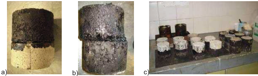
Figura 22 Conformado de probetas (sistema) de diferente sustrato;
