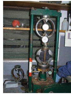
Figura 14. Inmersión en baño de agua termostataizado a 60 °C durante 40 minutos y ensayo de estabilidad/fluencia de las probetas
