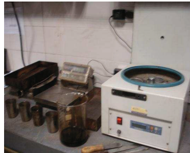
Figura 18. recuperación de finos mediante centrifuga de vasos
