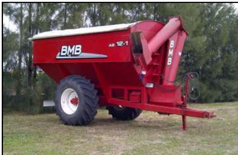
Figura N° 2: Tolva de 1 solo eje.
