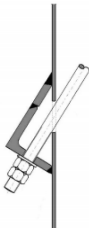
Figura 9: esquema de manguito roscado.
