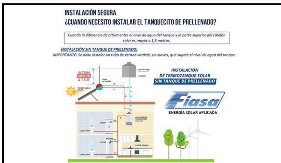
Figura 62. Termotanque Solar sin Tanque de Prellenado.
