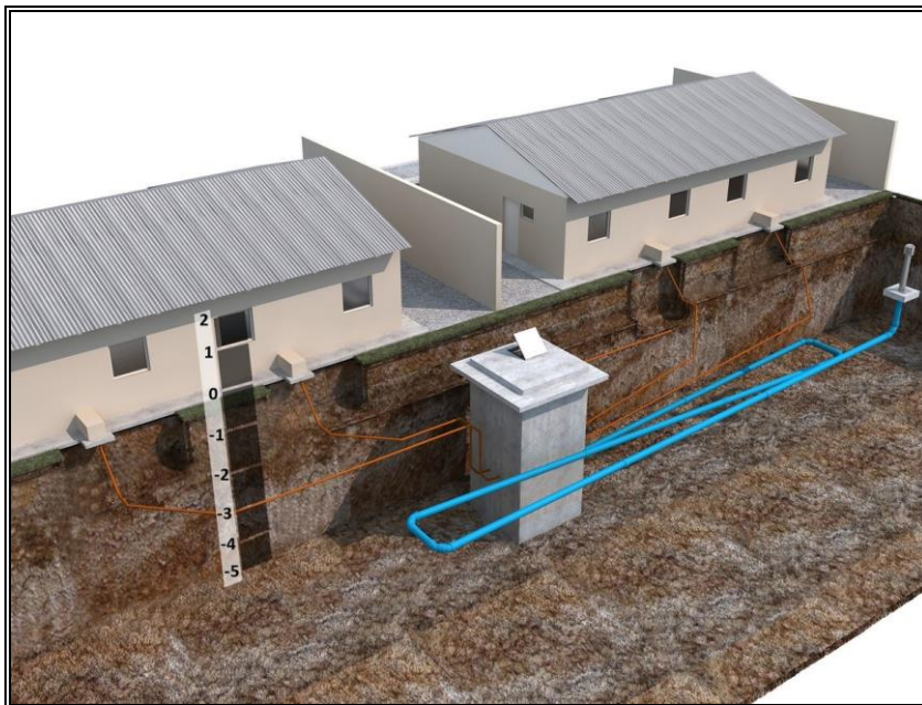
Figura 58. Tendido de cañerías para aprovechamiento de la temperatura del terreno por Geotermia.
