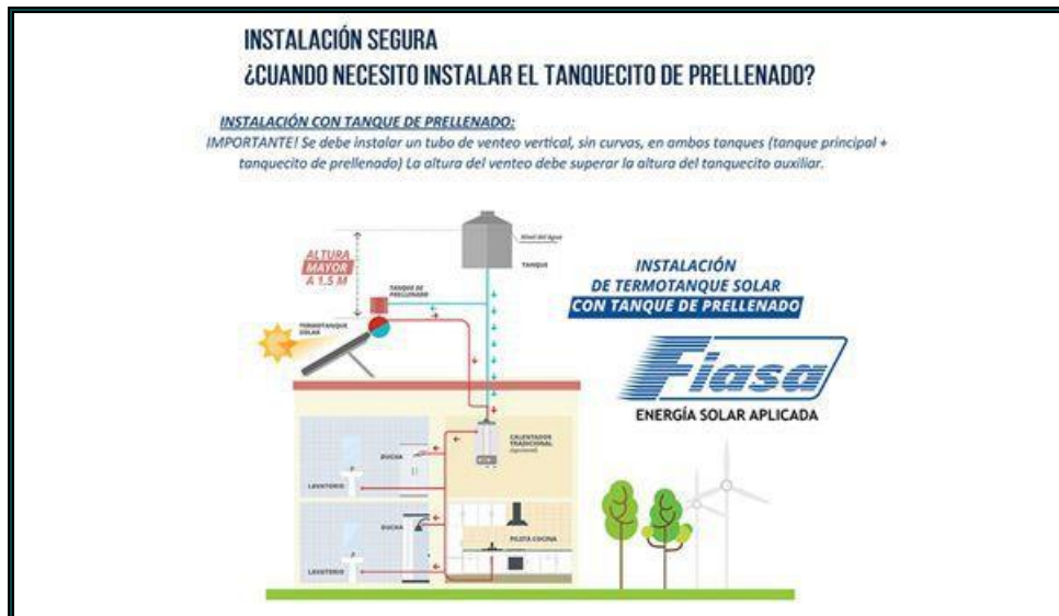
Figura 61. Termotanque Solar con Tanque de Prellenado.
