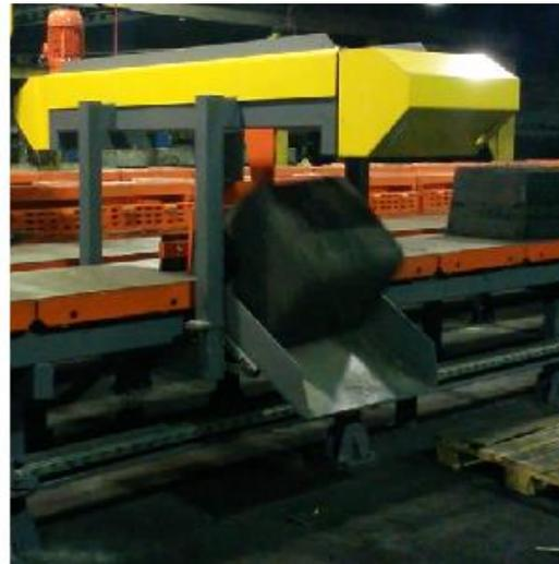
Imagen 3.2 - Push Out. – Elaboración propia. Imagen 3.3. Push out empujando al molde – Elaboración propia.
