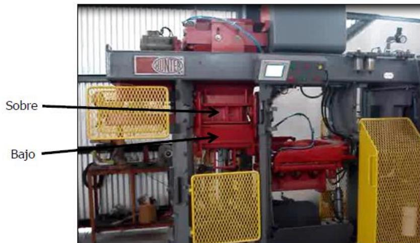
Imagen 2.9 - máquina de moldeo automático sin caja, de partición horizontal – Elaboración propia.
