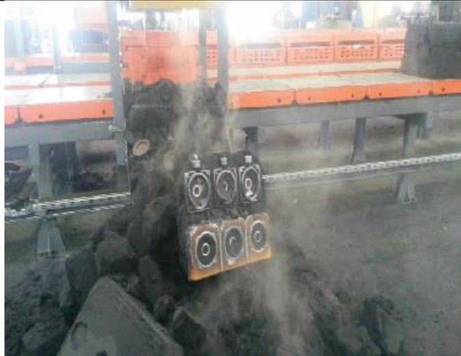
Imagen 3.4. Moldes listos para retirar pieza y desterronar. – Elaboración propia.
