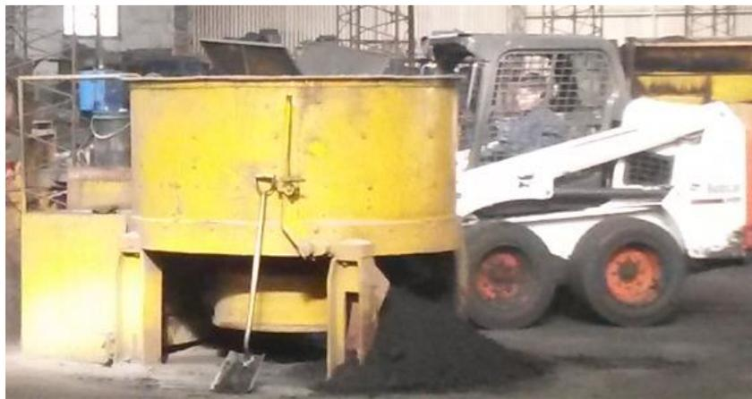
Imagen 3.7. Mini cargador alimentando molino. – Elaboración propia.
