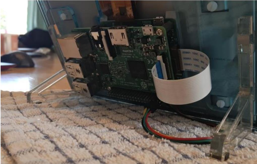
*Ilustración 7 Conexión pantalla táctil*
