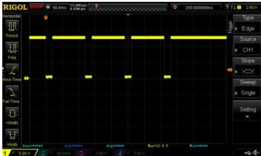
Ilustración 14 Moneda configurada para 4 pulsos, rápido.
