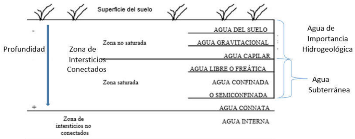
Figura 4: El agua en el subsuelo
