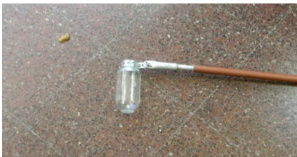
Foto 31: dispositivo para toma muestras
