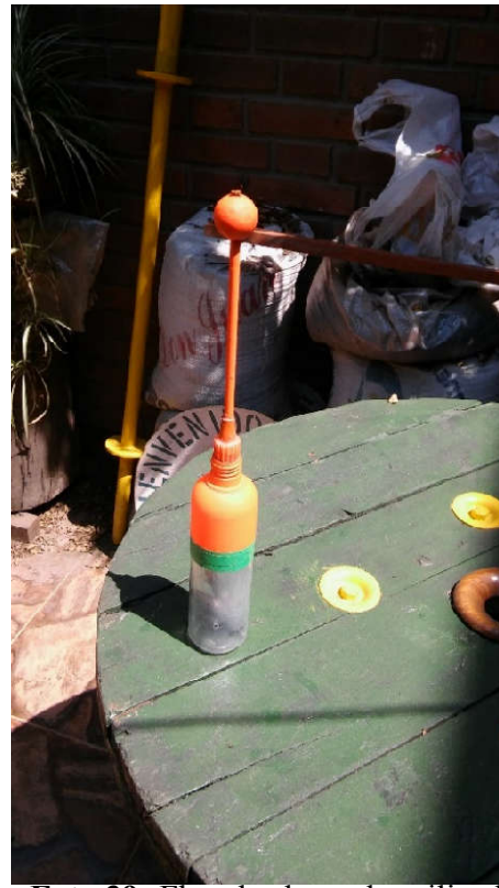
Foto 39: Flotador lastrado utilizado
