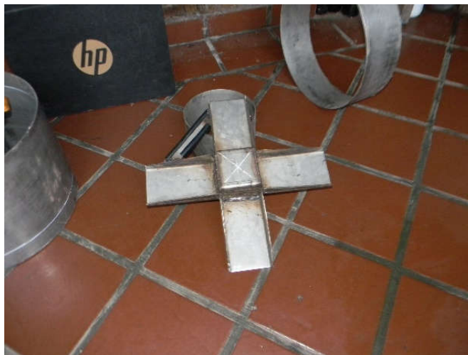
Foto N°13: Cruceta de impacto
