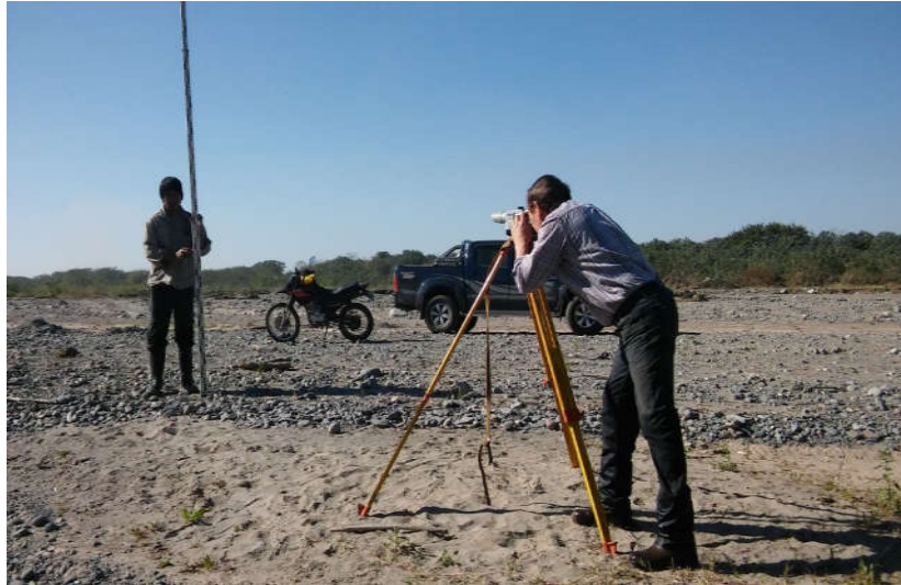
Foto 36: Levantamiento altimétrico transversal del cauce – aguas abajo
