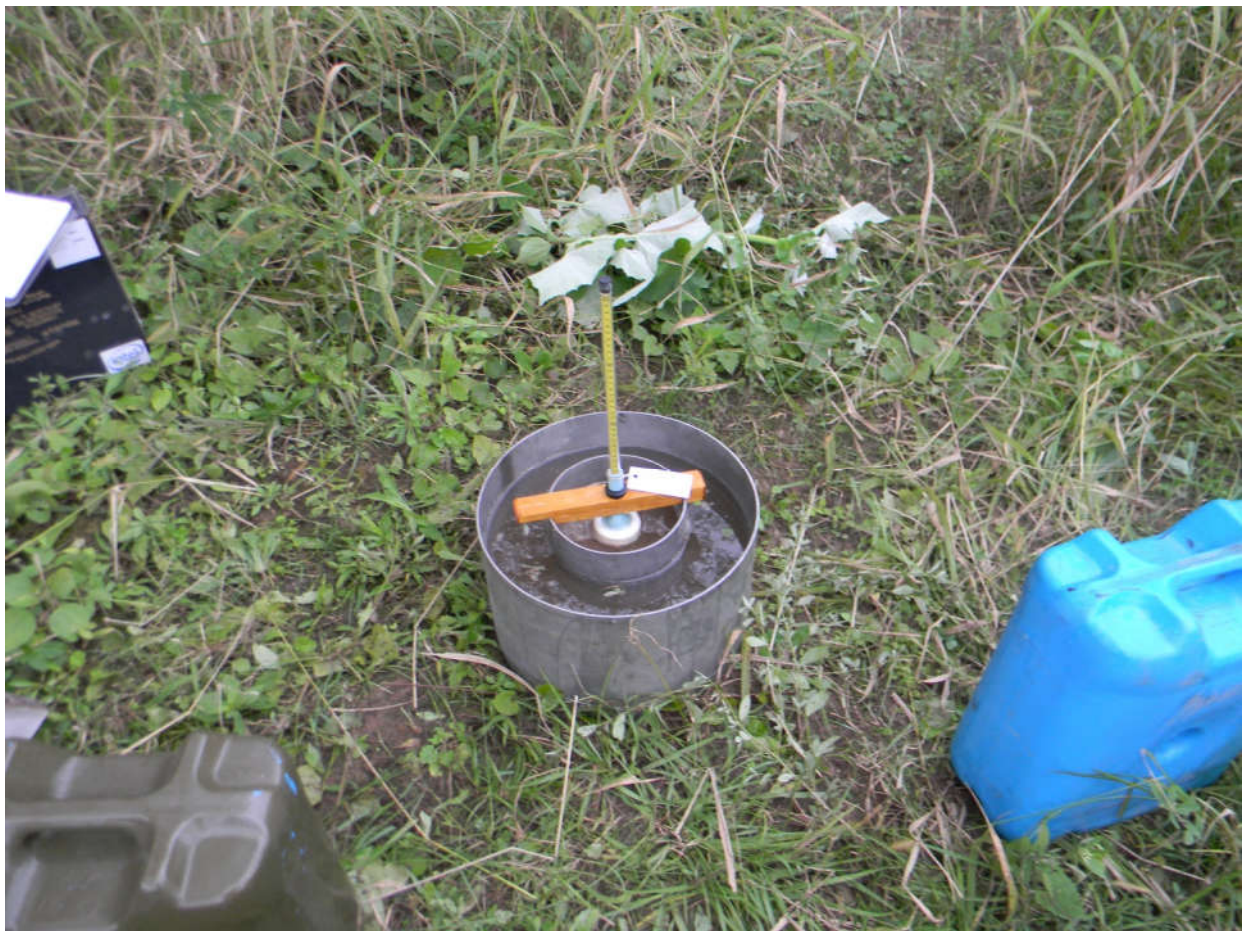
Foto 40: Infiltrómetro midiendo en Punto 1 (Tomado en Campaña)
