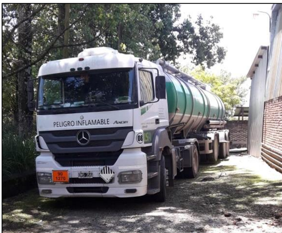
Figura 3.8: Camión cisterna de Salta Petrol retirando aceite lubricante usado.
