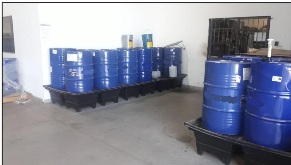
Figura 2.6: Almacenamiento de aceite lubricante nuevo en un taller oficial de camiones.
