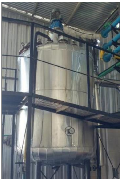
Figura 3.3: Instalaciones del destilador y calentador de fluido térmico.
