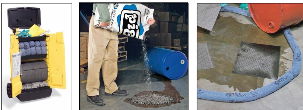
Figura 4.4: En las imágenes se muestra un kit antiderrame comercial y algunos materiales y tareas para contener un derrame.
