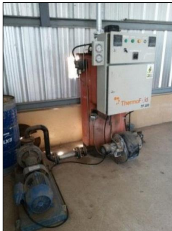
Figura 3.3: Instalaciones del destilador y calentador de fluido térmico.
