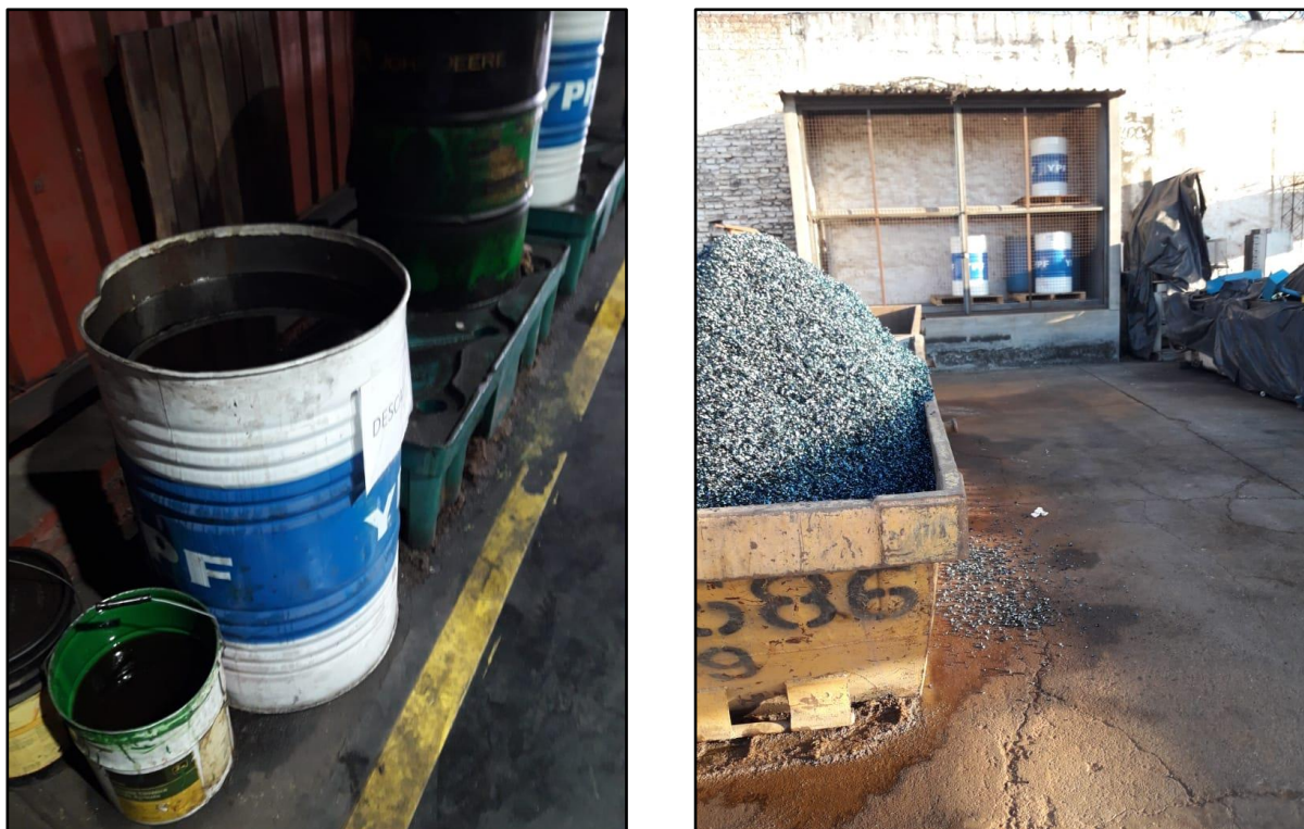
Figura 2.9: Almacenamiento de aceite en una empresa metalmeccánica. A la izquierda se observa el almacenamiento diario de aceite en desuso y a la derecha se observa el depósito en el exterior del taller.
