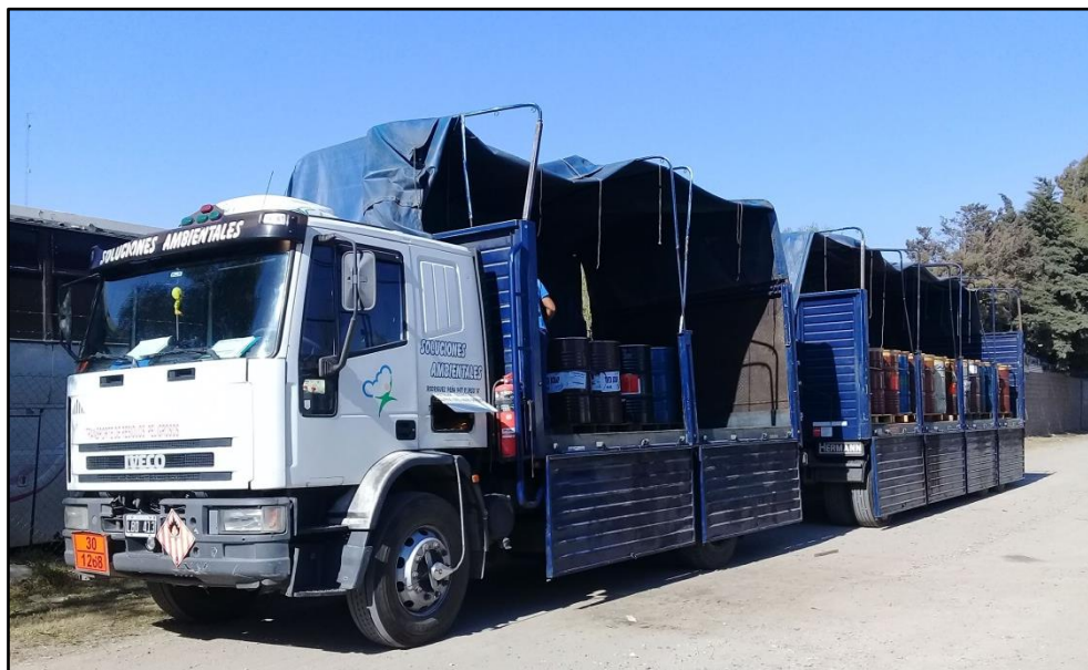
Figura 3.4: Transporte y descarga de residuos peligrosos sólido y/o líquidos en tambores.
