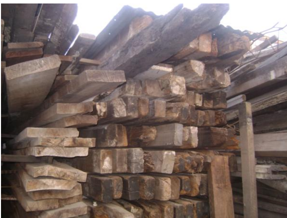
Fotografía 4-9.Vigas de madera recuperadas.
