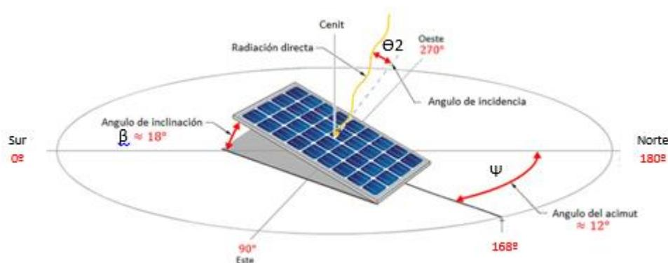
Figura 17; Variables en la incidencia de radiación solar sobre un panel. <http://panelessolarespr.com/solar101.html> (modificada por el autor).
