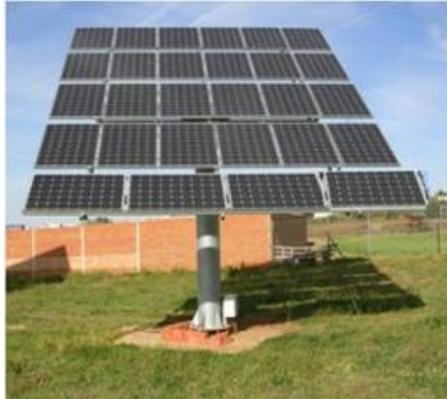
*Figura 19, Seguidor solar de eje vertical.*
