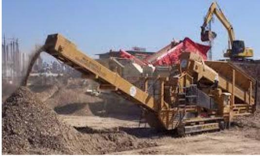
Fotografía 4-7. Trituradora de hormigón
