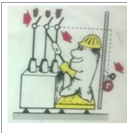
Fig. 7 Verificando ausencia de Tensión en Transformador
