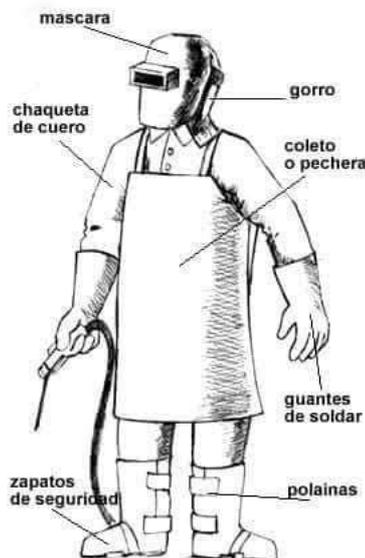
*Ilustración 40 Protecciones necesarias para soldadura*
