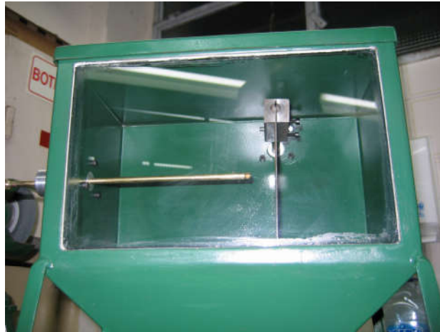
Imagen 2 – Interior de la cámara y las posiciones relativas del interior de la placa plana donde choca el fluido.
