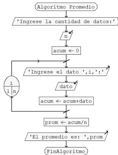
Fig.1.6. Diagrama de Flujo realizado con el software PSeint.
