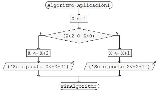
Fig. 1.7. Diagrama de Flujo Aplicación 1.
