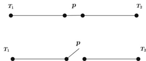
Fig. 1.3. Circuito de la Negación.
