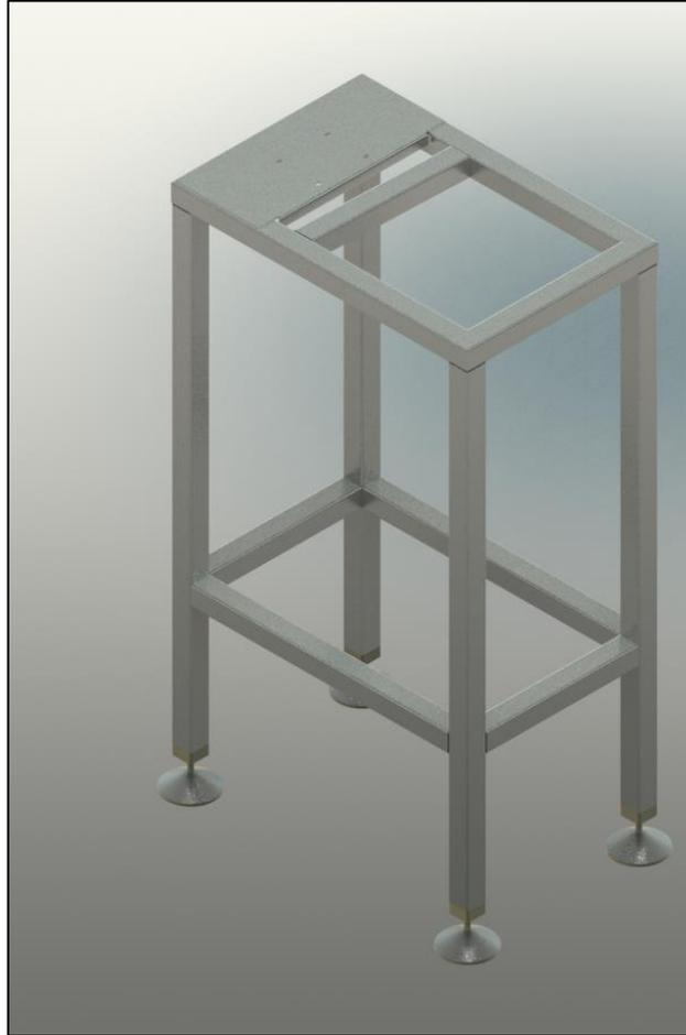
*Imagen 13D - Estructura de soporte del equipo con apoyos regulables*
