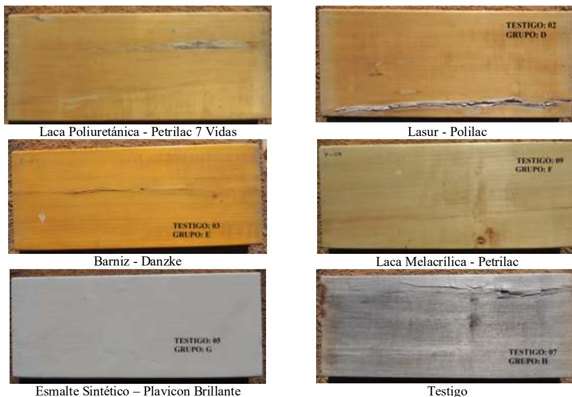
Fig. 4: Imágenes obtenidas en la tercera inspección de algunos testigos pertenecientes a distintos grupos
