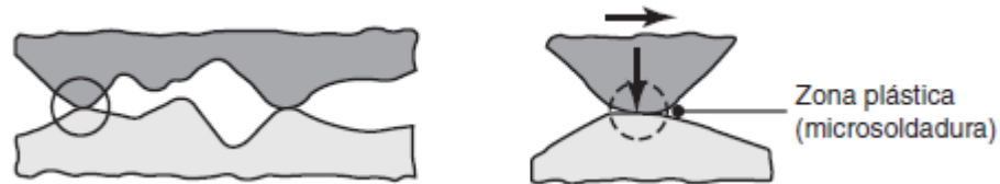
Figura AIV.28. Puntos de contacto entre dos superficies y su adhesión (Fuente: S. Kalpakjian, [47]).
