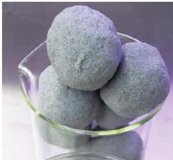
Figura AIV.4. Pellets abrasivos fabricados a partir de ceniza de cáscara de arroz (Fuente: C. P. Gil Salcedo, 2013 [72]).
