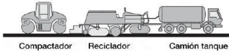
*Imagen 1 - Tren de avance típico reclamado en frío*
