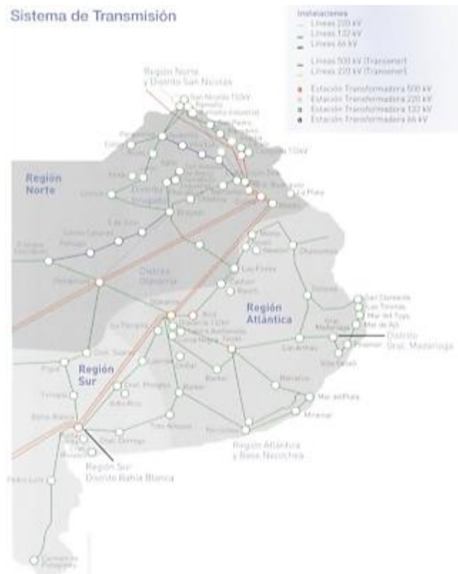
Figura N° 14: Red eléctrica de Buenos Aires.
