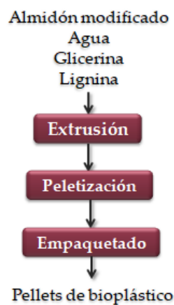
Figura N° 8: Diagrama de bloques del proceso de Formación del Polímero Biodegradable.
