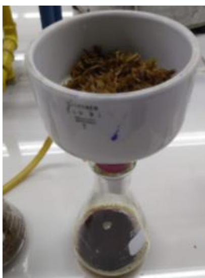
Figura N° 10: Filtración al vacío realizada en el segundo ensayo.
