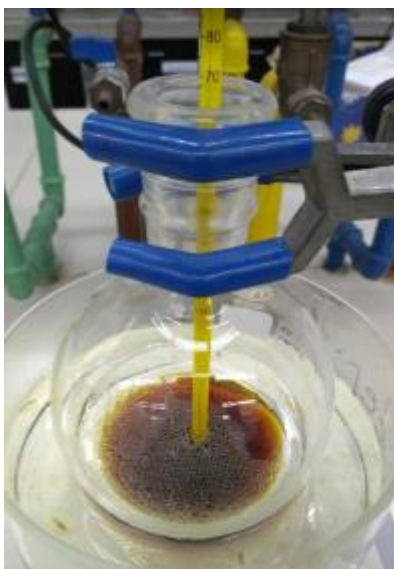
Figura N° 11: Evaporación del etanol en el primer ensayo.
