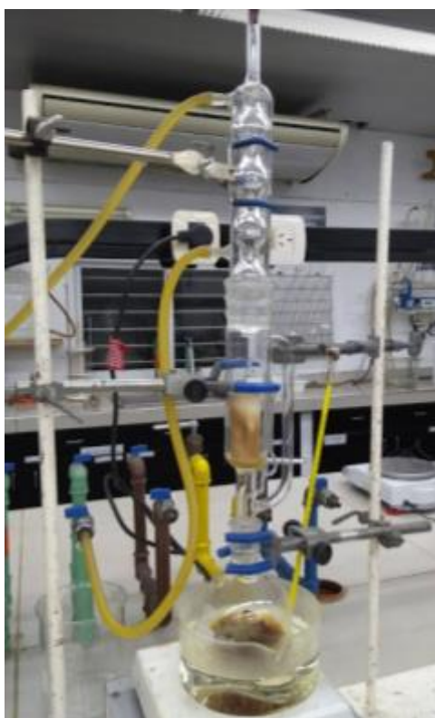
Figura N° 6: Equipo Soxhlet empleado en el primer ensayo.
