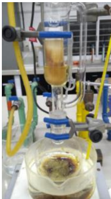
Figura N° 7: Acumulación de etanol en el cartucho poroso.
