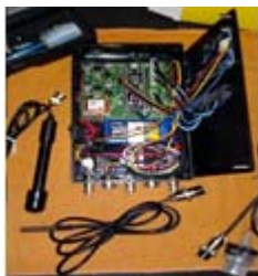
Figura 1. Visualización de la Construcción interna del instrumento de medición de variables ambientales.
