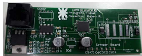
Figura 2. Sensor Multiparamétrico No Invasivo de Glucosa en Sangre, Temperatura, Oxígeno en Sangre y Ritmo Cardíaco.
