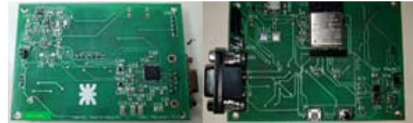
Figura 4. Placa principal de Medidor por Reflectancia/Transmitancia NIR No Intrusivo de Glucosa en Sangre, Temperatura, Ritmo Cardíaco y Oxígeno en Sangre.
