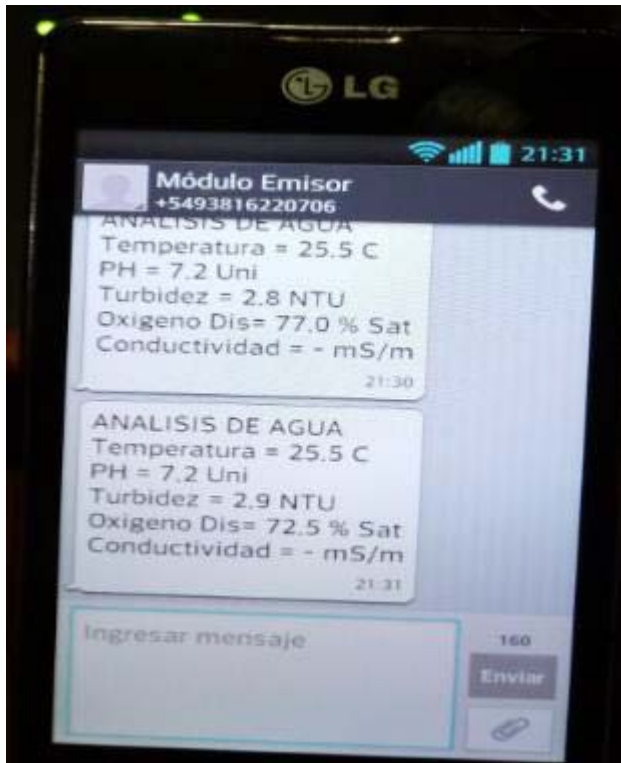
Figura 4. Visualización de Medición de Variables Ambientales en un Celular transmitidas por IoT.
