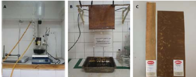
Figura 1. A) Síntesis de resina base; B) Impregnación y secado de papeles; y C) Laminados decorativos.
