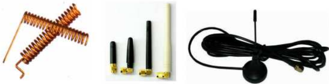
Figura 16. Posibles antenas para el Módulo SX1278.
