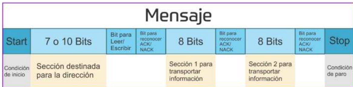
Figura 26. Formato de trama protocolo I2C.
