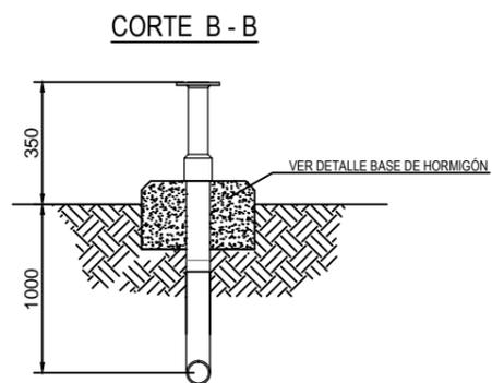
DETALLES BASE H°A° ENCOFRADO
