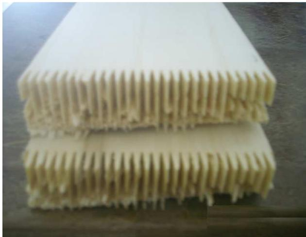
Figura 16 – Rotura tipo S, poca presencia de fibra
