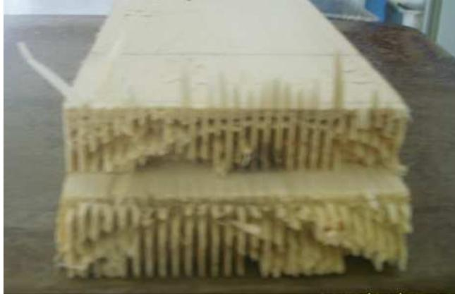
Figura 15 – Rotura tipo S, mucha presencia de fibra
