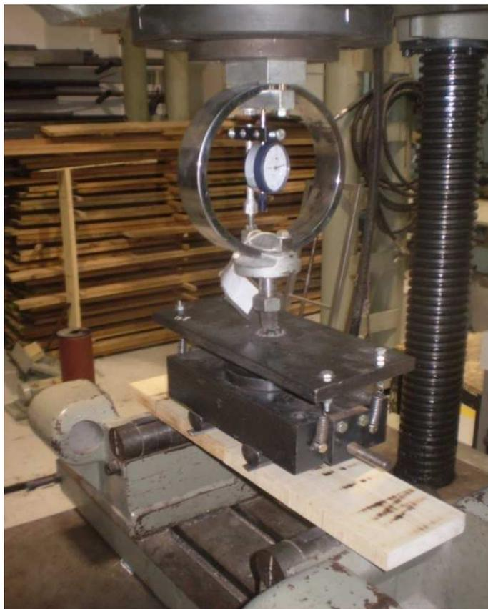
Figura 13 – Ensayo a Flexión
