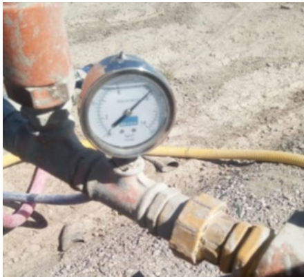
Figura 36.7: Manómetro para el control de presión de inyección
