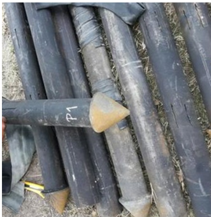
Figura 35.5: Tubos ranurados y punta de hinca
