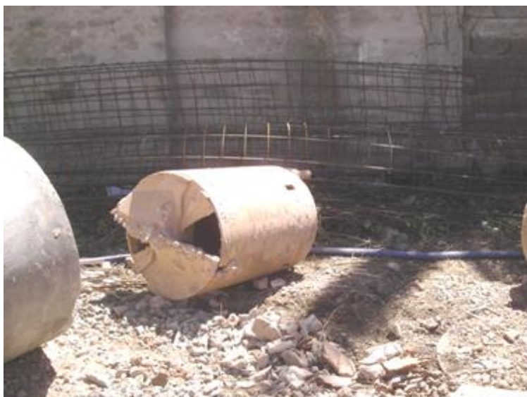
Figura 35.4: “Balde de perforación
