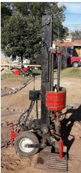
Figura 35.6: Equipo de hinca mediante impactos dinámicos
