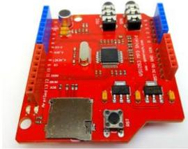
Figura N°23: Modulo VS1053 MP3 Shield<sup>(2)</sup>
