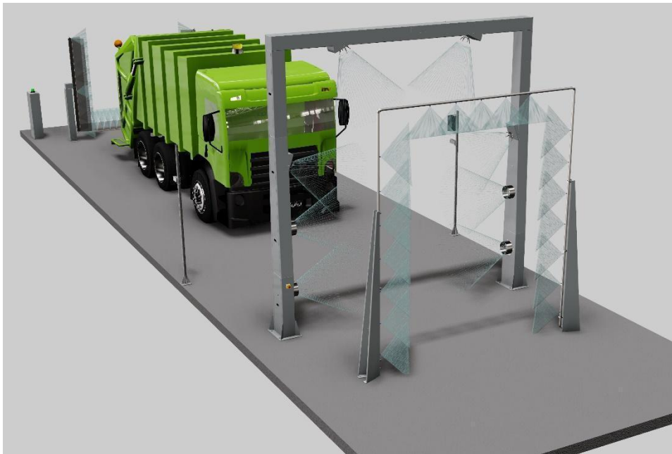
Gráfico 15: Túnel de lavado por arcos (vista frontal)
