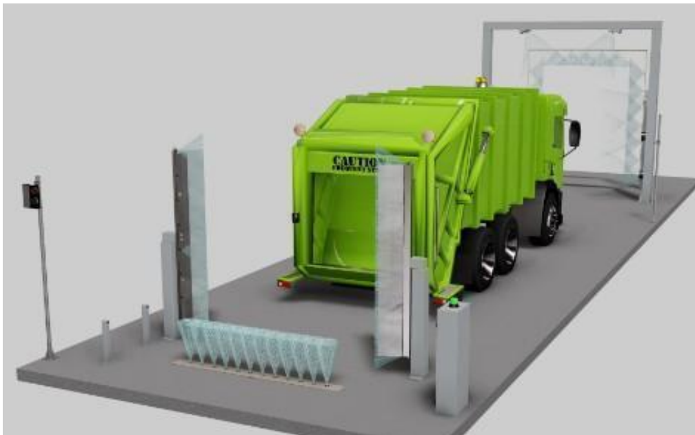
Gráfico 16: Túnel de lavado por arcos (vista posterior)
