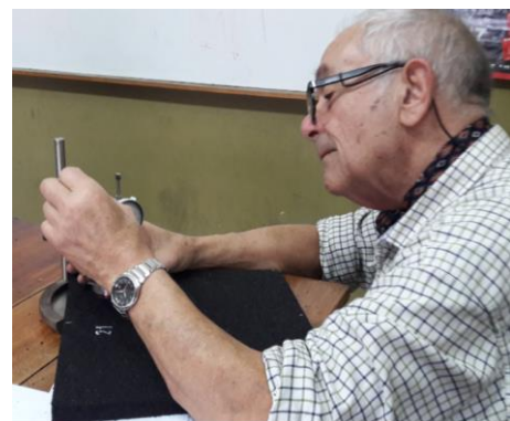
Figura 13: Medición de los espesores de una baldosa.
