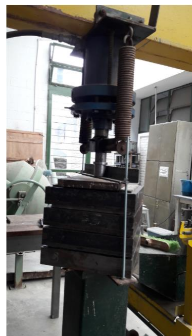
Figura 9: Colocación del sistema para mantener la presión.
