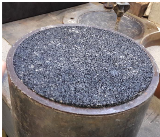
Figura 3: Probeta antes de ser desmoldada
