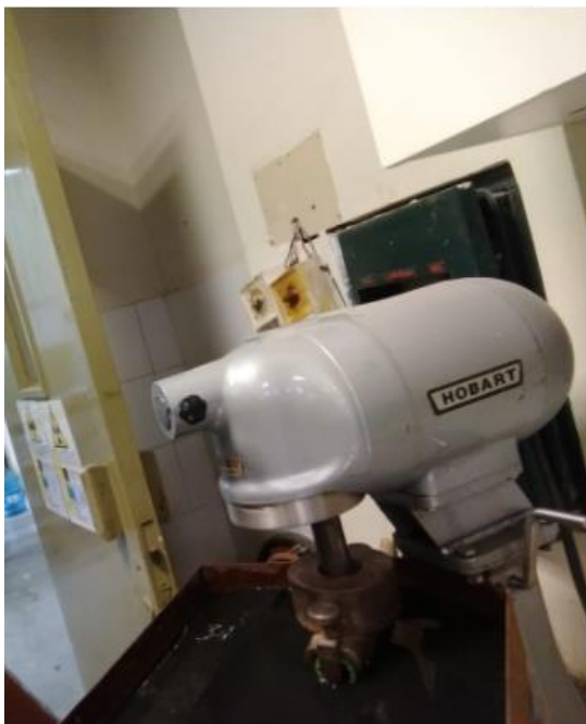
Figura 16: Ensayo de abrasión sobre una baldosa a escala real.
