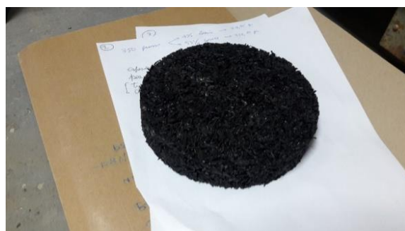
Figura 5: Probeta con problemas de fragüe.
