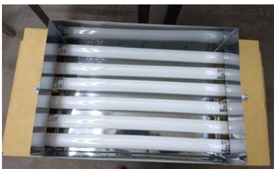
Figura 24: Vista de la cámara donde se aprecian los tubos UV.
