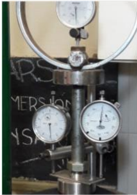
Figura 18: Equipo de ensayo Marshall preparado para ensayo de compresión.
