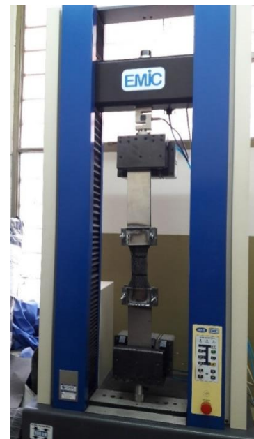
Figura 21: Muestra durante el ensayo de tracción.
