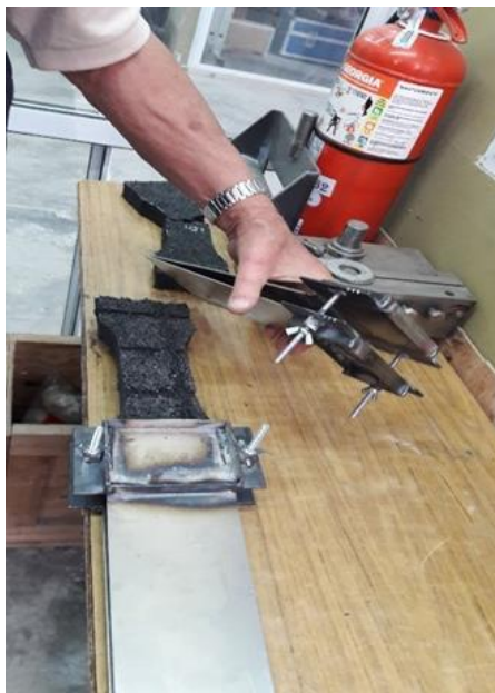
Figura 22: Preparación de las mordazas de sujeción.
