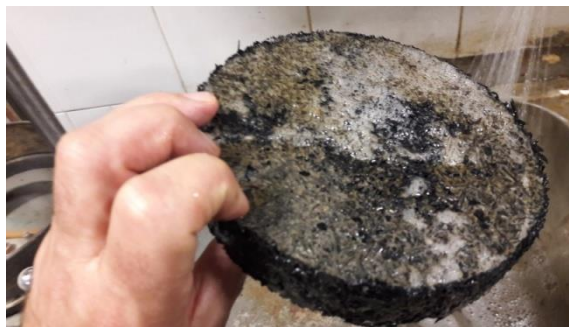
Figura 3: Alcohol polivinílico como desmoldante
