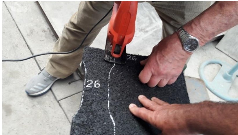
Figura 20: Corte de la muestra para ensayar en el equipo de tracción.
