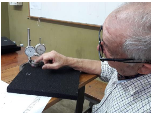
Figura 12: Preparación para la medición de los espesores.
