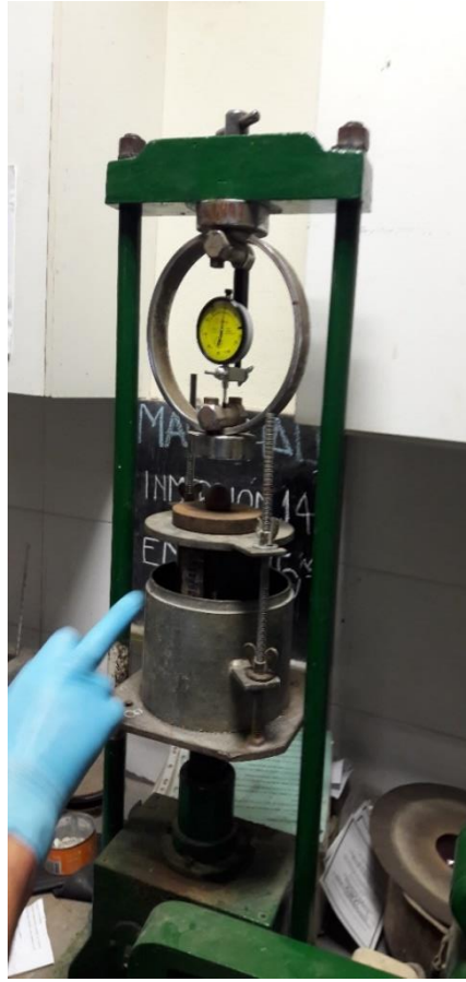
Figura 4: Prensa Marshall durante el proceso de compresión de la muestra.
