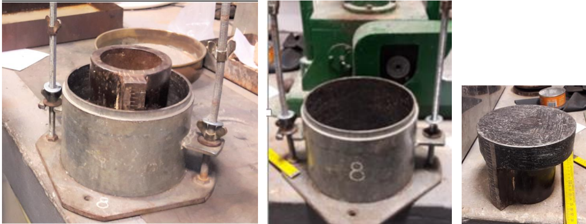
Figura 2: Sistema de moldes utilizado, armado y sus componentes por separado.
