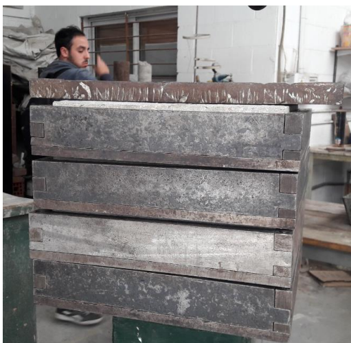
Figura 8: Paquete de moldes preparados en la base de la prensa.
